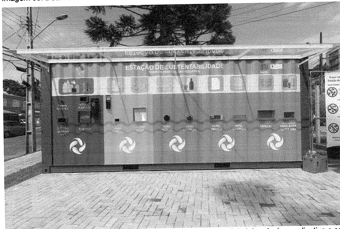
Imagem 07: Estação sustentabilidade instalada, com impressão digital de adesivo explicativo e cobertura em policarbonato transparente.
