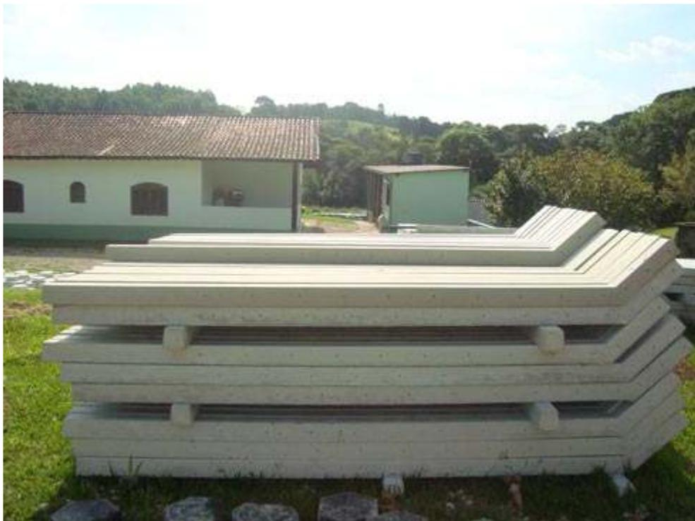
Mourões de concreto ou palanques são peças pré-moldadas utilizadas na confecção de cercas.
