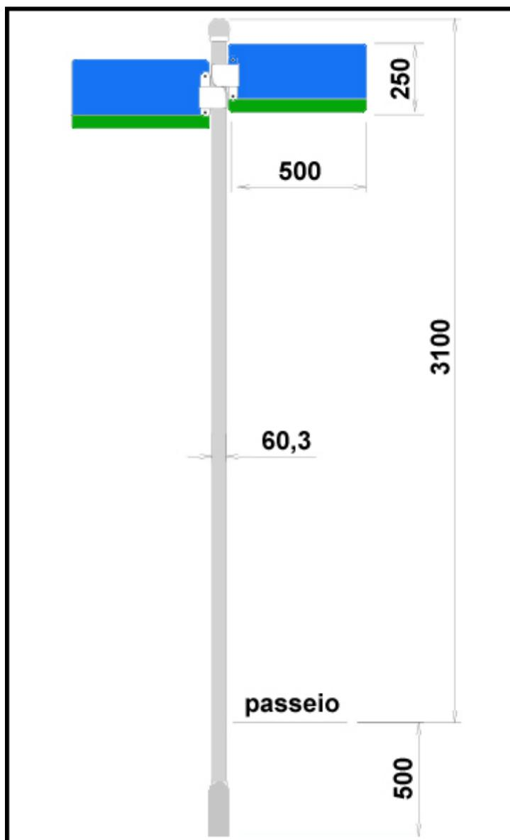
*Ilustração 2: Detalhe do poste (medidas em mm)*
